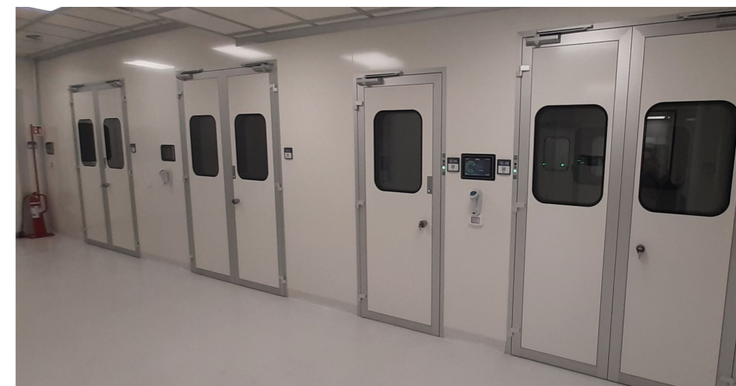
Singolo e doppio battente con visive ad angoli arrotondati Single and double door leaf with rounded corners windows Simple et double vantaux avec fenêtres à angles arrondis
